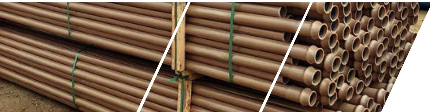
Os tubos são fabricados em PVC-U rígido segundo a norma NBR 5647 e EN1452. O sistema de ligação será do tipo “JER” – tubo com bolsa para ligação por junta elástica auto-travante. Da gama de fabricação constam os seguintes tipos de tubulação: Hidropress PBA transporte de fluidos sob pressão, fabricado nas classes de 0.6, 0.75 e 1.0 MPa, com diâmetros de 50 a 100 mm. As conexões são fabricadas na classe de pressão 1.0 MPa e possuem uma vasta gama de tipos e diâmetros.
